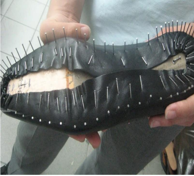
Resim 8 : Kalıba çivi dizilmesi işleminin yapılması
