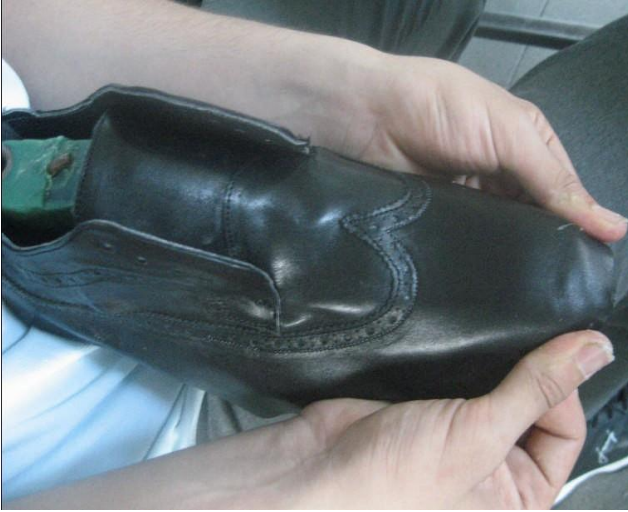
Resim 7 : Sayanın Kalıba Yerleştirilmesi
