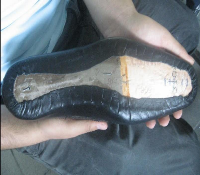
Resim 9: Çivilerin kalıptan sökülüş hâli
