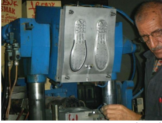
Resim 10 : Tabanın kalıplama tekniği ile basılması
